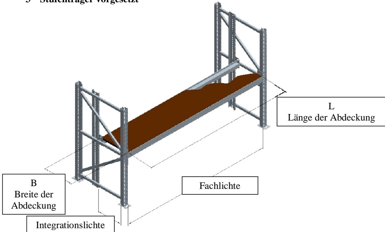
Die Stufenträger sind für eine Dicke der Fachabdeckung von 22 mm ausgelegt!
